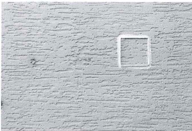
Рисунок 5 – Зовнішній вигляд дослідного фрагменту 2 з опорядженням штукатуркою мінеральною Ceresit CT 35 (2,5 мм):
